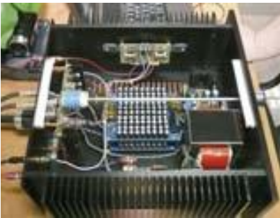
Оцените конструктив гибридного усилителя VicSound: дискретный регулятор громкости, мощный Ш-образный трансформатор и сглаживающий фильтр из множества конденсаторов небольшой мощности. У компании есть и другая модель, где выходные транзисторы питаются от импульсных источников с высоким КПД
