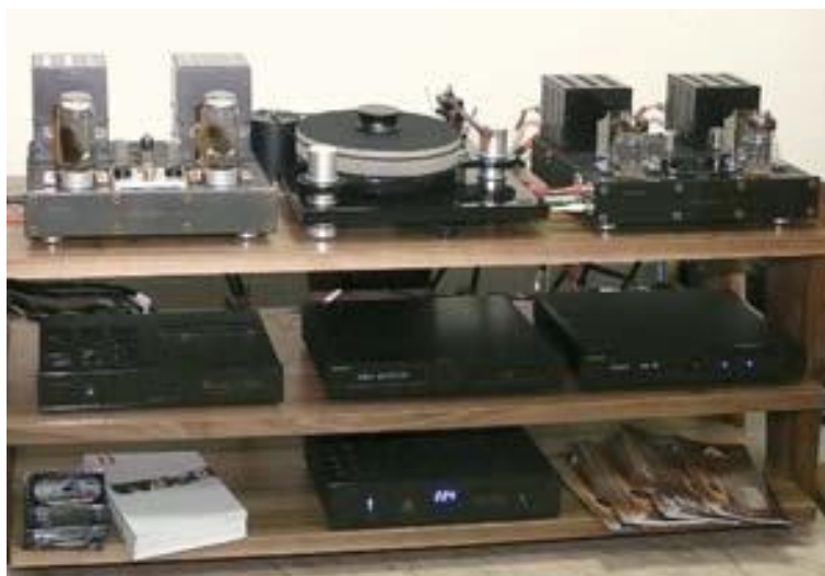
Ассортимент «Алекса» пополнился виниловым проигрывателем Turn 1, созданным совместно с немецкой компанией Block. Она поставляет двигатели, диски и тонармы, всё остальное делается на фабрике в Щербинке. Главная особенность конструкции — точный трекинг, что позволяет использовать MC-картридж с прижимной силой 0,6 г. Проводящий мат отводит статические заряды через шпindel на массу
