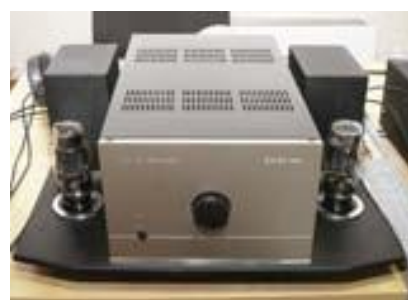
Владимир Стародубцев (фирма «ЗВ», Таганрог) решил сделать бюджетный усилитель, по качеству звучания не уступающий старшим моделям. Снижена лишь выходная мощность (8 Вт на канал), другие характеристики на прежнем уровне. На выходе — двойные триоды 6Н13С в параллельном включении
