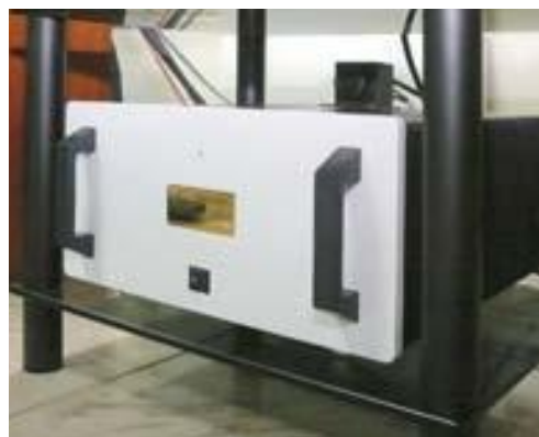
Раньше «Лаборатория Анашкина» специализировалась на ламповых усилителях, но недавно выпустила гибридный оконечник мощностью 200 Вт на 4 Ом. Выходные каскады построены на полевых транзисторах 2SK1058/2SJ162, по пять штук в плече
