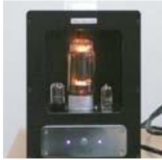
40-ваттный однокатник AudiostandArt на ГМ-70 имеет полосу усиления при полной мощности 25 Гц — 60 кГц. Благодаря глубокой обратной связи радикально снижены искажения, в спектре присутствует в основном вторая гармоника. В усилителе используется собственная схемотехника с катодными повторителями между всеми каскадами
