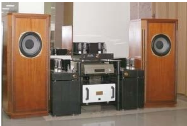
Раньше «Лаборатория Анашкина» специализировалась на ламповых усилителях, но недавно выпустила гибридный оконечник мощностью 200 Вт на 4 Ом. Выходные каскады построены на полевых транзисторах 2SK1058/2SJ162, по пять штук в плече
