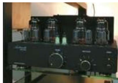
Новое детище Константина Мусатова — интегральный «Антрацит» на 6С33С с полным дистанционным управлением и процессорным контролем режимов ламп. С пульта можно перевести выходной каскад в режимы «А» или «АВ». Разработан и новый транзисторный усилитель, который скоро должен пойти в производство
